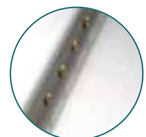
Sistema de lavagem da zona de trabalho Cleaning system for work surface with water jets
